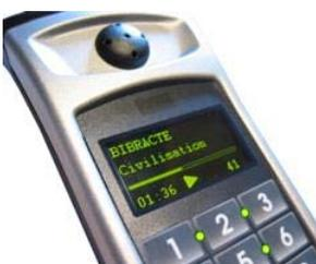
A ce stade, l'observation de l'afficheur permet de vérifier en plus du texte défilant : la durée totale du message, le numéro du message, et un curseur renseigne sur la position d'écoute dans le temps.
